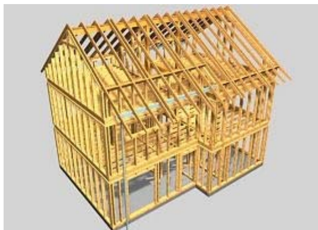
computerunterstützte 3D-Zeichnung eines Systemelementhauses
